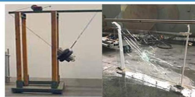
...balaustra a norma con prova del pendolo UNI EN12600!!!
